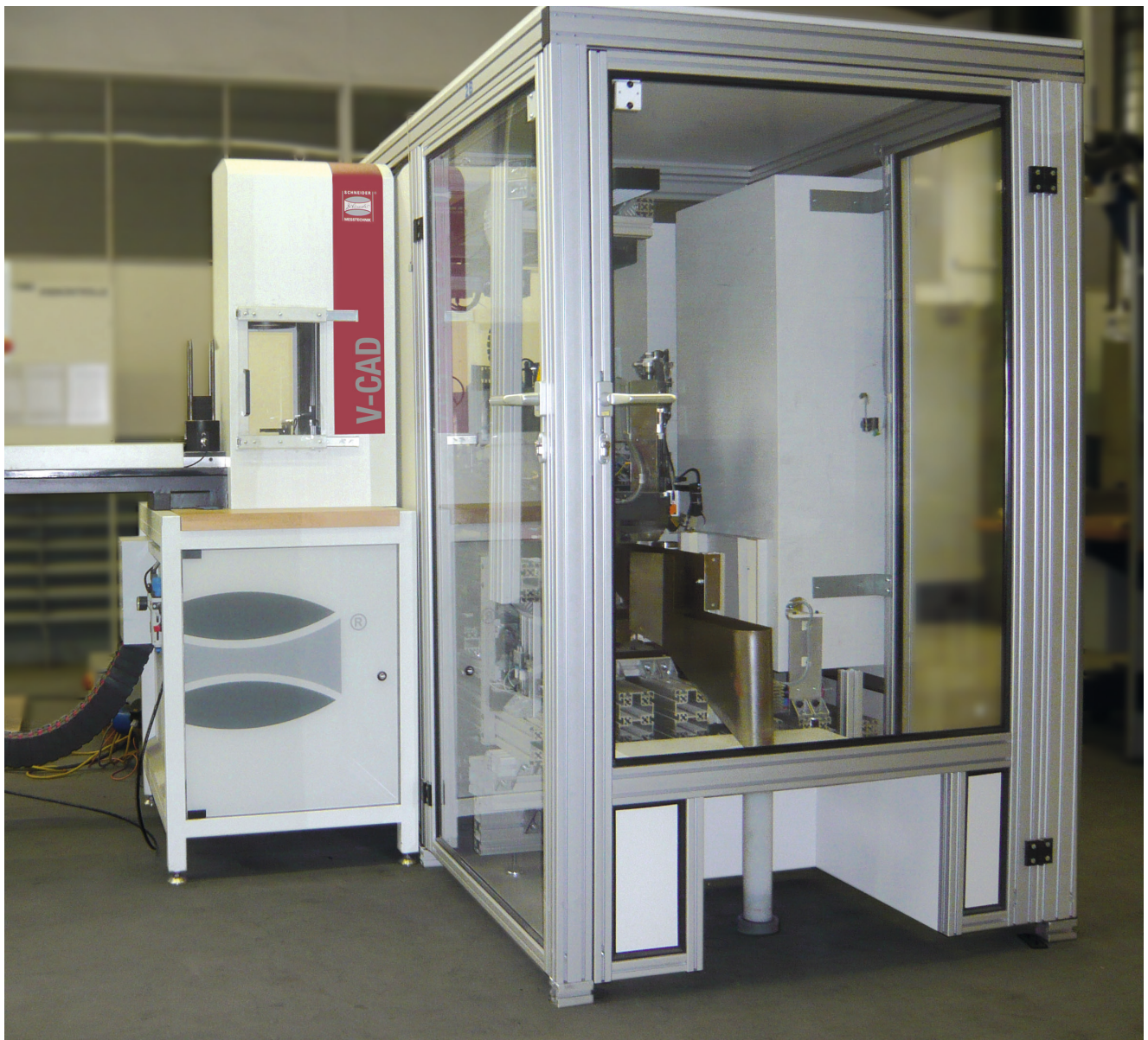
测量元件，配备两个 V-CAD 模块和后续包装单元。
