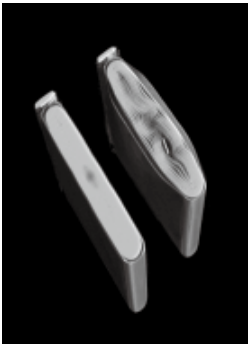
全新电池和性能下降电池的 Volume Rendering图像
