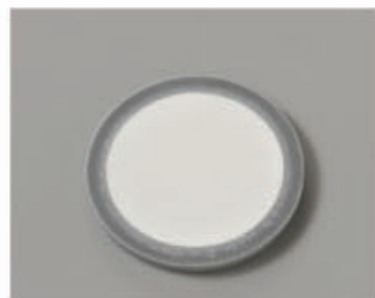
用压片机加压成形（压力成型法）
