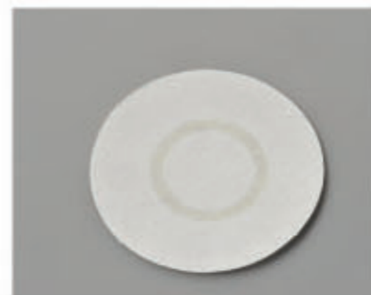
将样品滴在滤纸上干燥后进行检测分析
