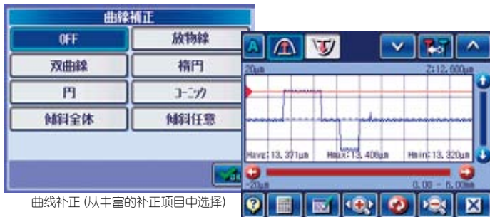
简易轮廓形状解析示例 (凸段差)
