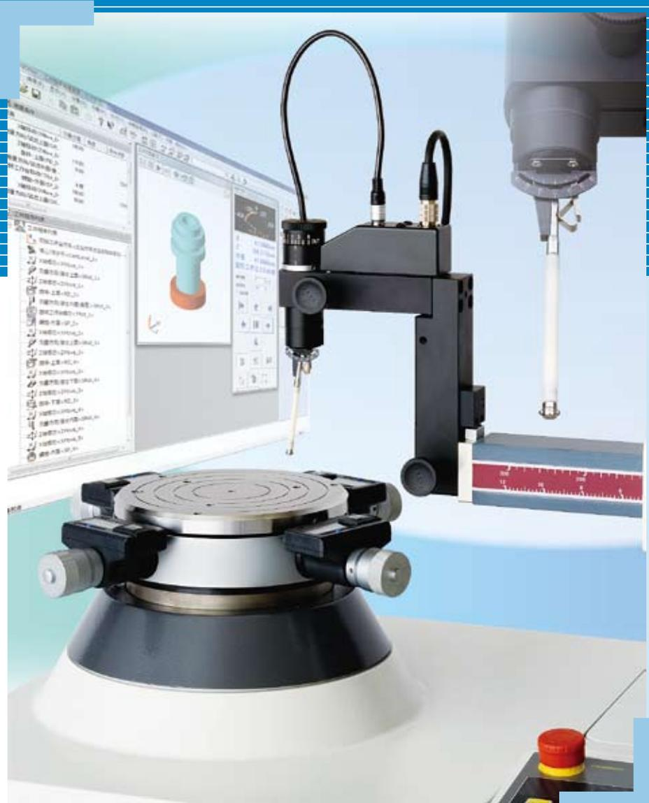
一款全新 PC 对应的圆度和圆柱度测量仪器，其广泛的分析功能适用于多种工件的测量。
