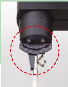
检测器装置 (处于垂直方向时) 上增加了传感碰撞功能，可以避免 Z 轴方向上的碰撞。此外，当检测器偏转超过一定范围时，新增加的意外碰撞保护功能可以使系统停止。当检测到偶然触碰时，专用分析软件 (ROUNDPAK) 可以感应到误差并自动停止系统。
