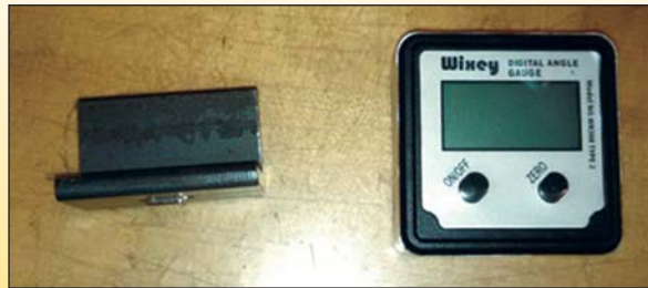
图一：对角仪安装座（左）和数字式对角仪（右）
