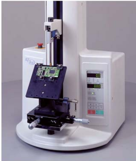
45°拉脱强度试验
