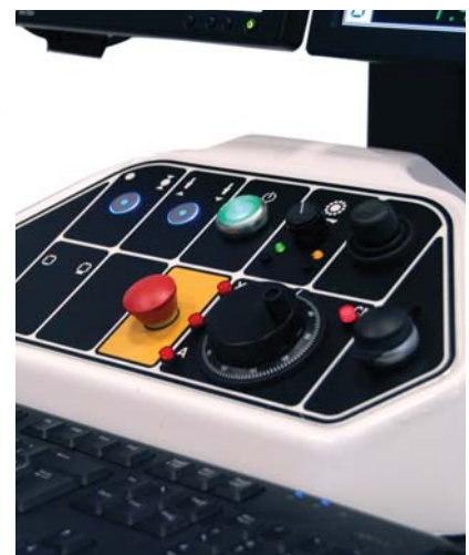
微调手轮 微调手轮、操作杆与独立轴的选择在最大的易用性与人体工程学角度整合进了控制室。
