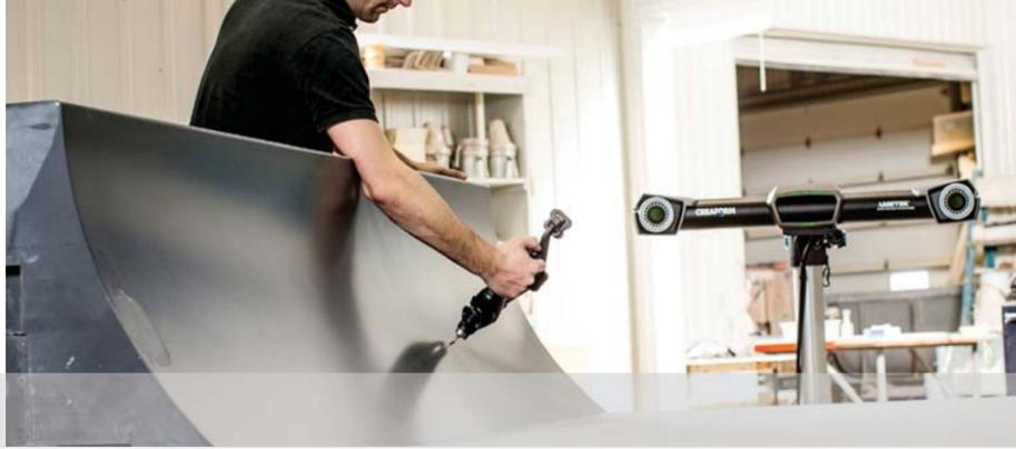
**HandyPROBE Next™** 便携式光学三坐标的测量精度不受环境不稳定因素的影响。无需固定的测量设置，部件、光学跟踪器和无线探头在测量过程中均可随时移动。系统专为车间应用而设计，具有灵活性，测量范围相对其他便携式 CMM 更广。
