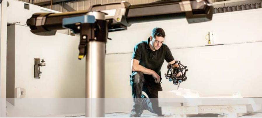
**MetraSCAN 3D™** 光学 CMM 扫描仪无需固定的测量设置，车间测量精度不受环境不稳定因素的影响。其测量范围可以扩展，测量速度惊人，且有复杂材料的数据采集能力，也是用于替代传统便携式 CMM 的实用产品。
