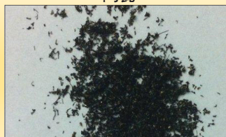
切屑几乎就像粉尘一样。建议使用压缩空气对切屑进行吹除。
