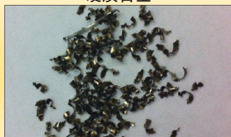
常见的卷曲状切屑。形状和长度取决于立铣刀的槽型和切削参数。
